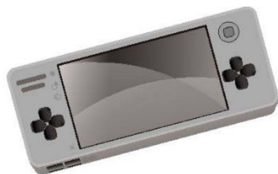
▲ La carcasa es la cubierta externa que protege las partes internas del aparato. Esta tiene forma rectangular.
